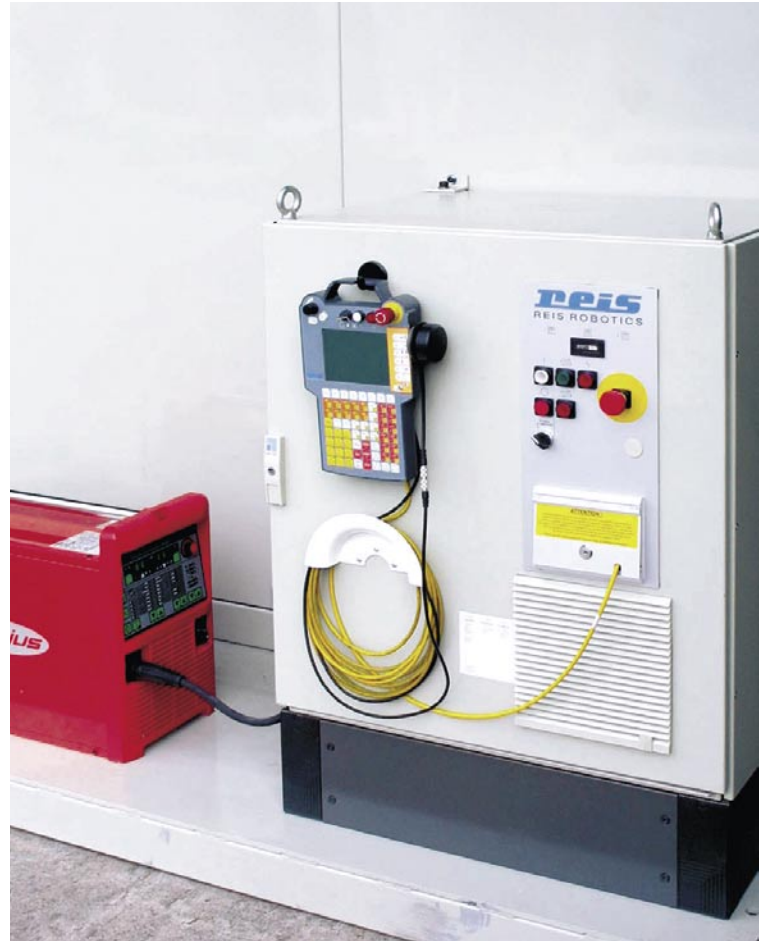
▲ Robotersteuerung und Schweißstromquelle rückseitig geschützt auf durchgehenden Grundrahmen aufgebaut. Zentraler Medienanschluss.
