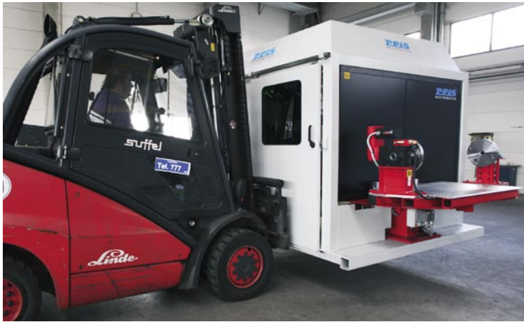
▲ Transportable Schweißkabine mit 3t-Gabelstapler. Abmessungen ausgelegt für LKW- oder Containertransport.
