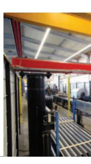
die an die individuellen Anforderungen des Kunden angepasst wurde. Diese Lösung bietet klare Vorteile: Eine externe SPS ist nicht erforderlich und Bedienung und Programmierung der Linearroboter gestalten sich schnell und einfach über das Programmierhandgerät.
