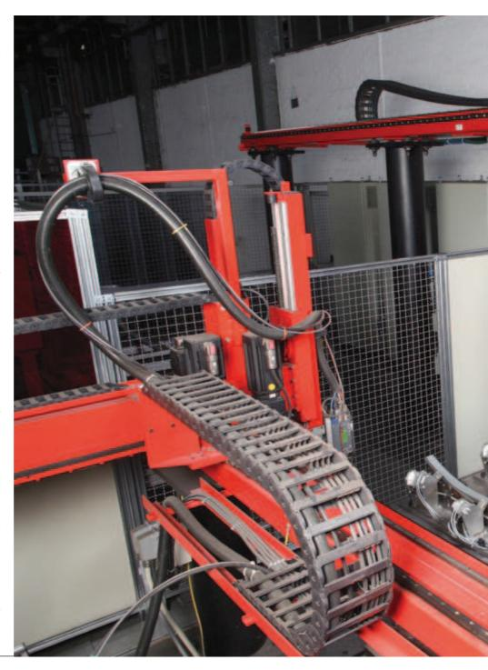
fähigeren Bolzenschweißanlage. Sie besteht aus drei Linearrobotern des Typs SRL 26, wobei ein Roboter zur abwechselnden Beschickung der beiden anderen als Schweißroboter ausgelegten SRL 26 dient.
