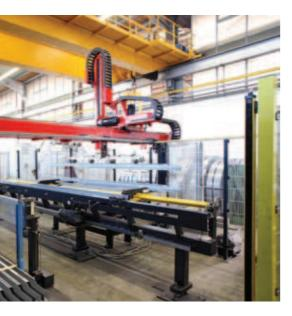
tenschaum versorgt. Ebenfalls zur Anlage gehört ein Drehtisch vom Typ RMD 01 mit zwei Arbeitsstationen. Die Steuerung des Roboters erfolgt über die Reis-interne SPS wie bei den Schweißrobotern.
