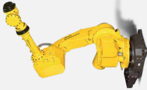
FANUC R-2000iB 210WE – Version für den Nassbetrieb
